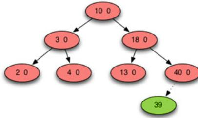
**Fig. 10.1** AVL Tree Case 1—No Pivot Node
